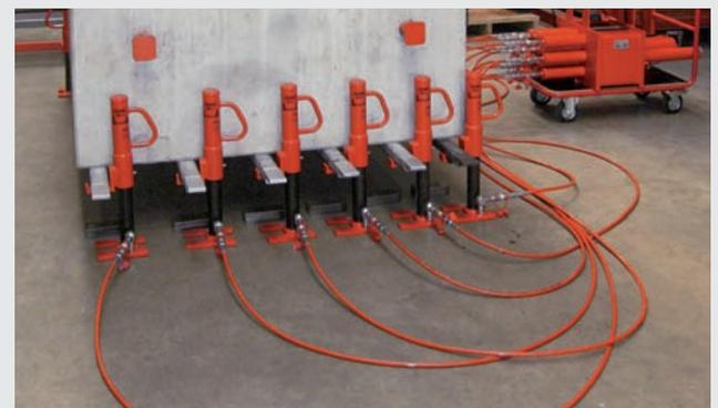
Sonderdruckblock zum synchronen Anheben mit 12 Hebeegeräten
