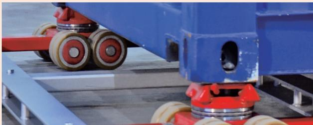
„Weld-on Cone“ für Lenk- und Fahrwerke Serie K (technische Daten siehe S. 18-19, 22-24, 29)
