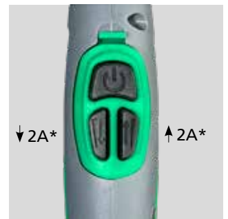
Up/Down modul med 3-knapps-avtryckare för justering av svetsström. Svetsströmmen ökas/minskas med 2 ampere. Långt tryck för konstant ökning/minskning.
